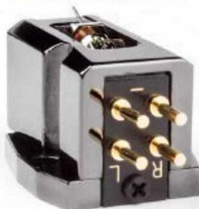
Zwar nicht farbcodiert, aber trotzdem gut abzulesen: die massiven vergoldeten Pins des PP-300
