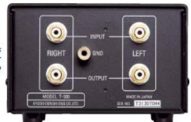
Anpassungsmöglichkeiten gibt es nicht, dafür passt der Übertrager exzellent zum System PP-300
