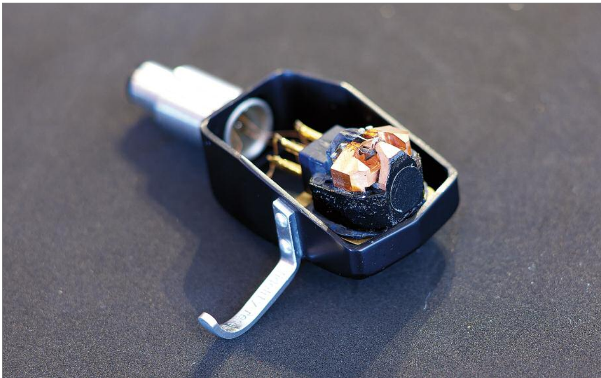
Ikeda Rebuild in der FR Headshell. Thomas hat auch hier das System komplett vom Gehäuse befreit
