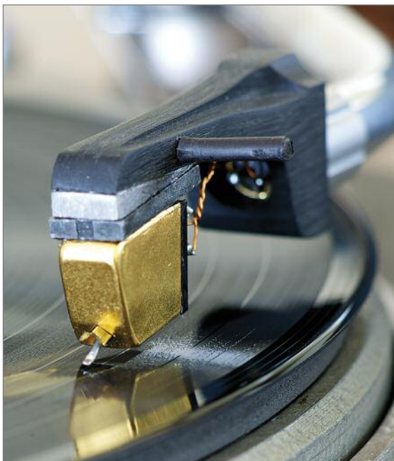
Nagaoka DJ Umbau – Thomas befreit das MM-System von allen resonierenden Gehäuseteilen. Ein Spaßmacher zum Freundschaftspreis
