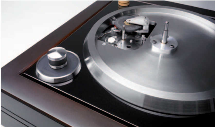
KRAFTVOLL: Das rubingelagerte Reibrad vermittelt zwischen der 5mm starken Motorwelle und der Innenseite des (hier abgenommenen) Tellers. Das resultierende Drehmoment ist enorm.
